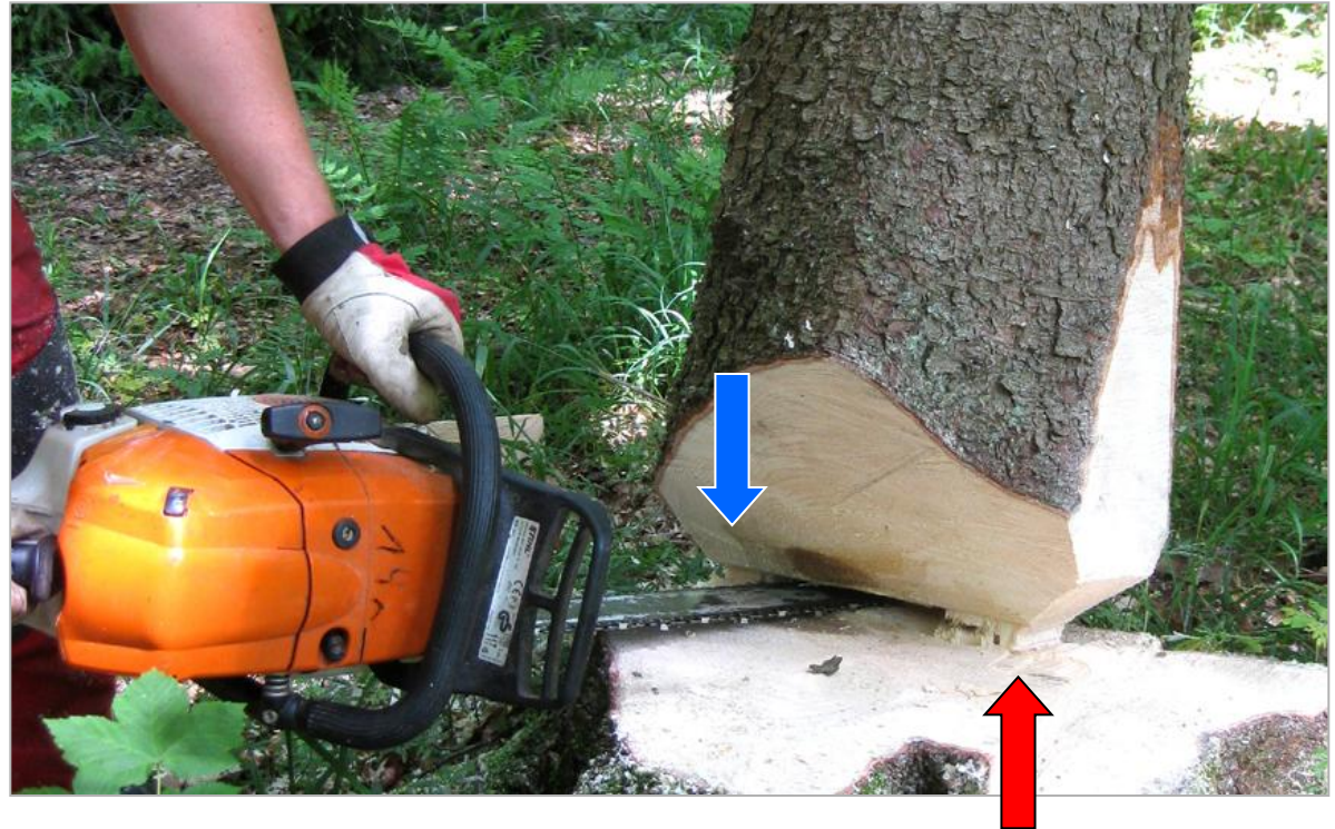
Zugang zur Bruchleiste frei schneiden
