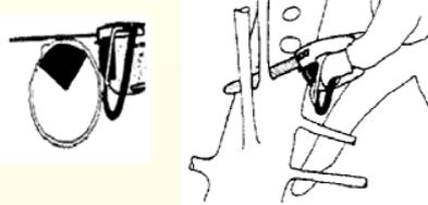
Die Motorsäge nach links schwenken. Die linke Hand gleitet dabei am Bügel nach oben. Körpergewicht auf das linke Bein verlagern. Die MS auf dem Stamm und am rechten Bein abstützen. Äste mit auslaufender Kette abtrennen.
